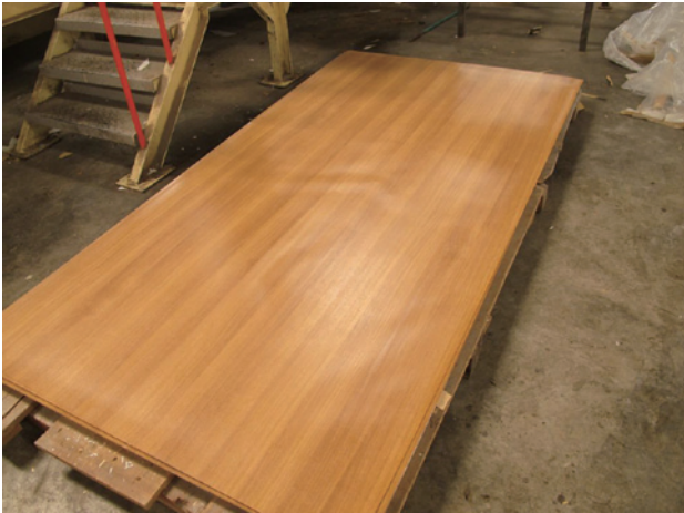
写真5 ユーカリ材から生産されたパーティクルボード (ティグライ州：H25.7)
